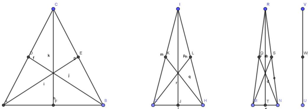
On prend un triangle isocèle et on détermine son centre de gravité. Il est situé au tiers de la hauteur de la base.
