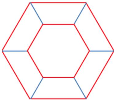
À l'aide d'une bande de papier et en utilisant un gabarit d'angle d'un triangle équilatéral, je peux réaliser les six trapèzes isocèles superposables formant la couronne visible de l'œil de bœuf.
