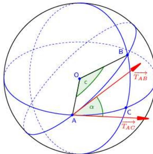
Par exemple, sur la figure,  $\widehat{AB} = \widehat{AOB} = c$ . Quant à l'angle au sommet dans un triangle sphérique, c'est l'angle formé par les tangentes aux grands cercles qui portent les côtés adjacents. Par exemple, sur la figure,  $\widehat{BAC} = \hat{A} = \alpha$ . On remarquera que c'est aussi l'angle entre les deux plans définissant les grands cercles en question (sur la figure, les plans (OAB) et (OAC)).
