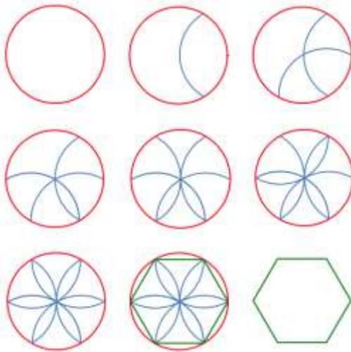
Nous nous intéresserons ici à quelques motifs réalisés à partir d'un hexagone régulier. Les outils utilisés par le tailleur de pierre étaient la règle, le compas et parfois l'équerre pour des gabarits d'angle.
