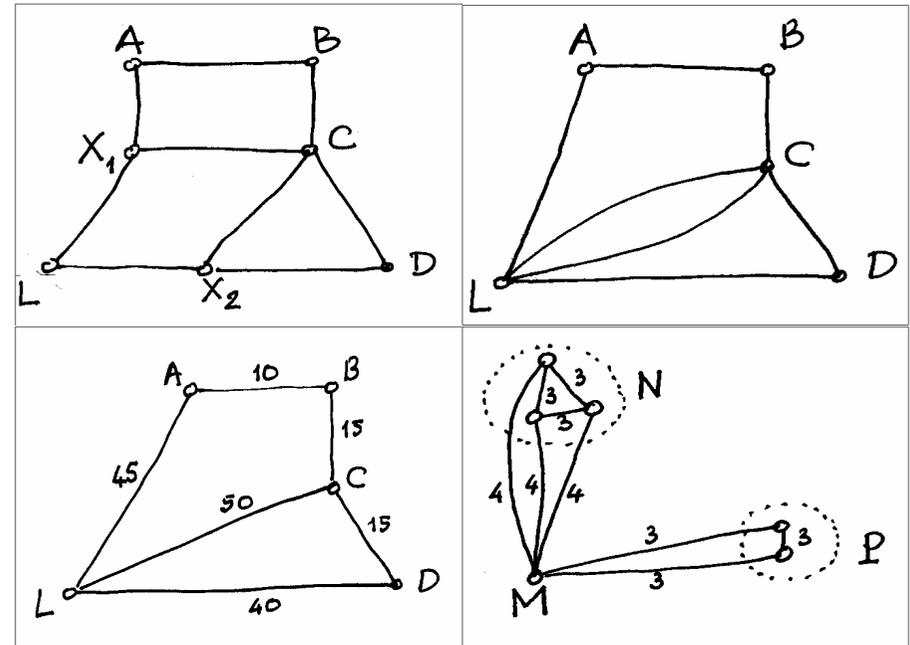
la figure 2 : il y a deux arêtes entre L et C, l'une correspondant à l'itinéraire  $L X_1 C$ , l'autre à  $L X_2 C$ . Ensuite on pondère les arêtes avec les temps de parcours, et s'il y a plusieurs itinéraires possibles entre deux points, on ne garde que le plus court en temps (figure 3).
